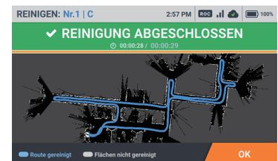
Routen mit abgeschlossener Reinigung werden blau angezeigt und Routen ohne abgeschlossene Reinigung weiß.
